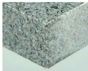
研磨が難しい箇所の艶出し 左切り出し部分 塗布面 右切り出し部分 無処理面 御影石
